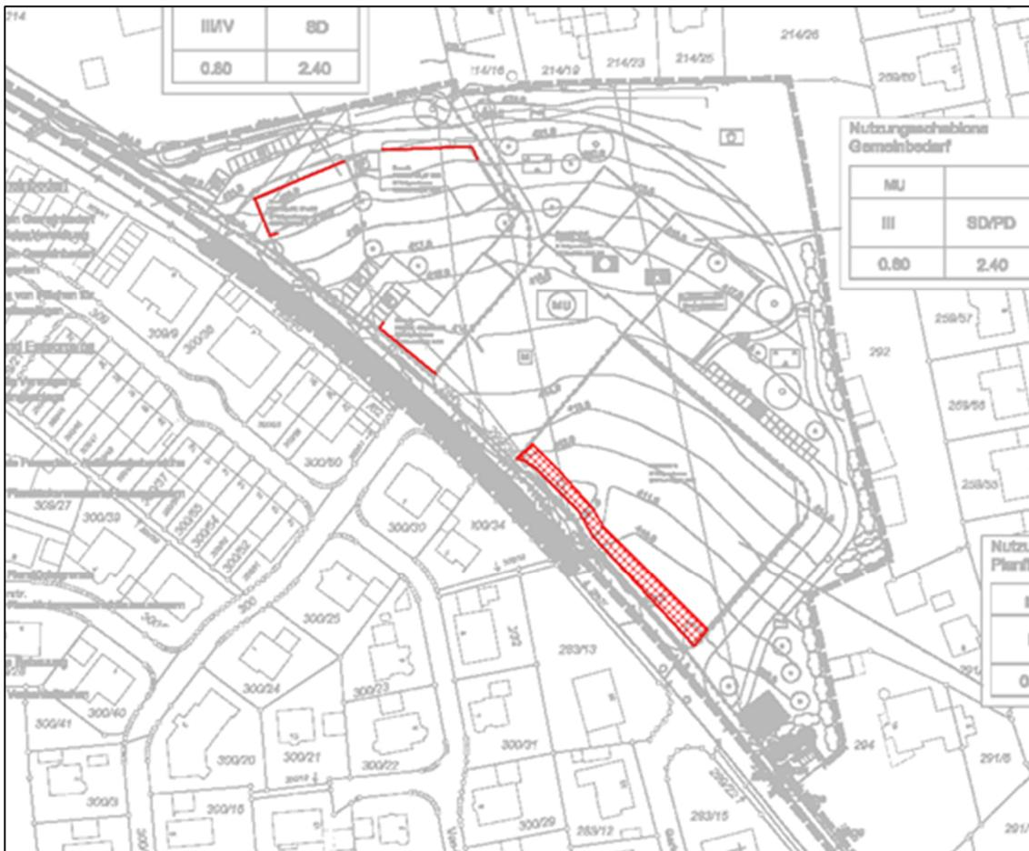
Abbildung 6: Lageplan mit Darstellung der Fassaden(-bereiche) an denen Schallschutzmaßnahmen erforderlich sind
