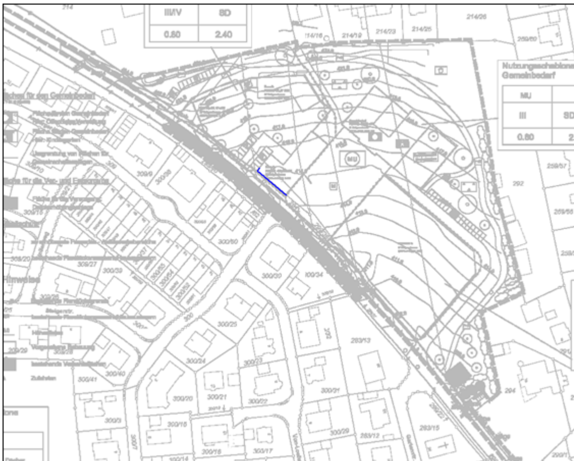
Abbildung 1: Lageplan mit Darstellung der Fassaden an denen Außenwohnbereiche geschützt werden müssen
