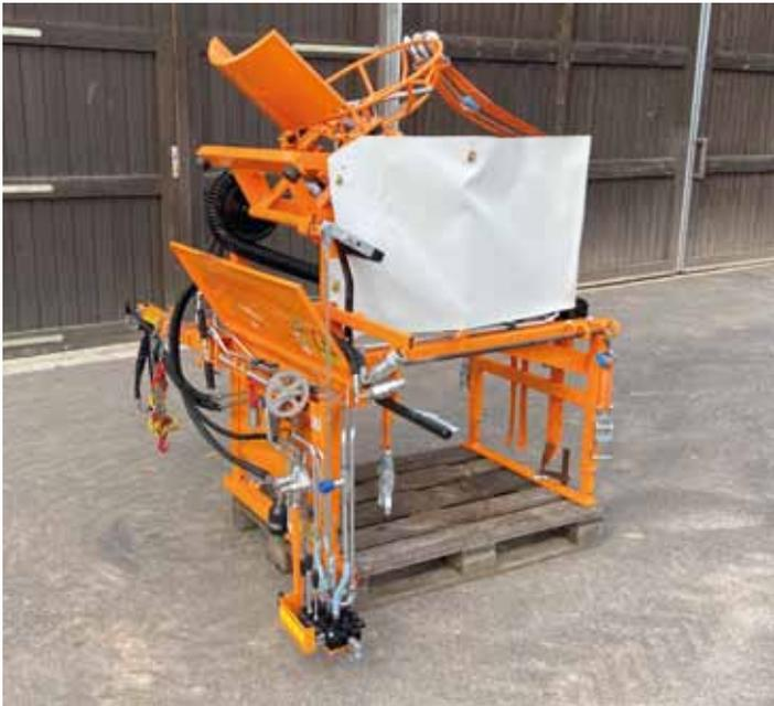
Der neue Sinkkastenreiniger, der für freien Abfluss des Oberflächenwassers sorgen wird. ©Gemeinde
